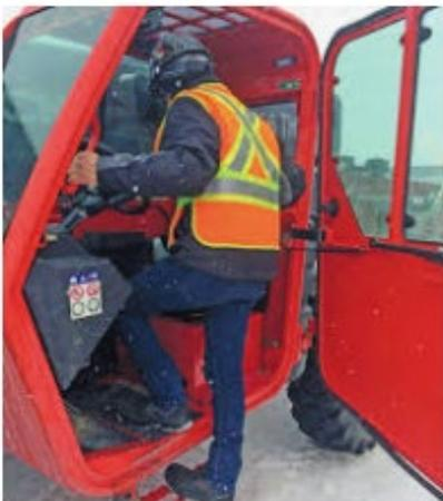
Porter des vêtements ajustés et ne comportant aucune partie flottante pour éviter tout danger de contact avec des pièces en mouvement (CSTC, art. 2.10.2.-a).
